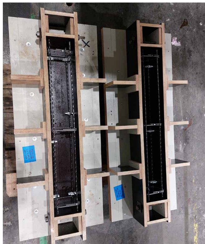
Figuur 2: Storten van beton uit de stortmachine bij Voorbij Prefab (links) en mallen met basaltwapeningsstaven (rechts)
