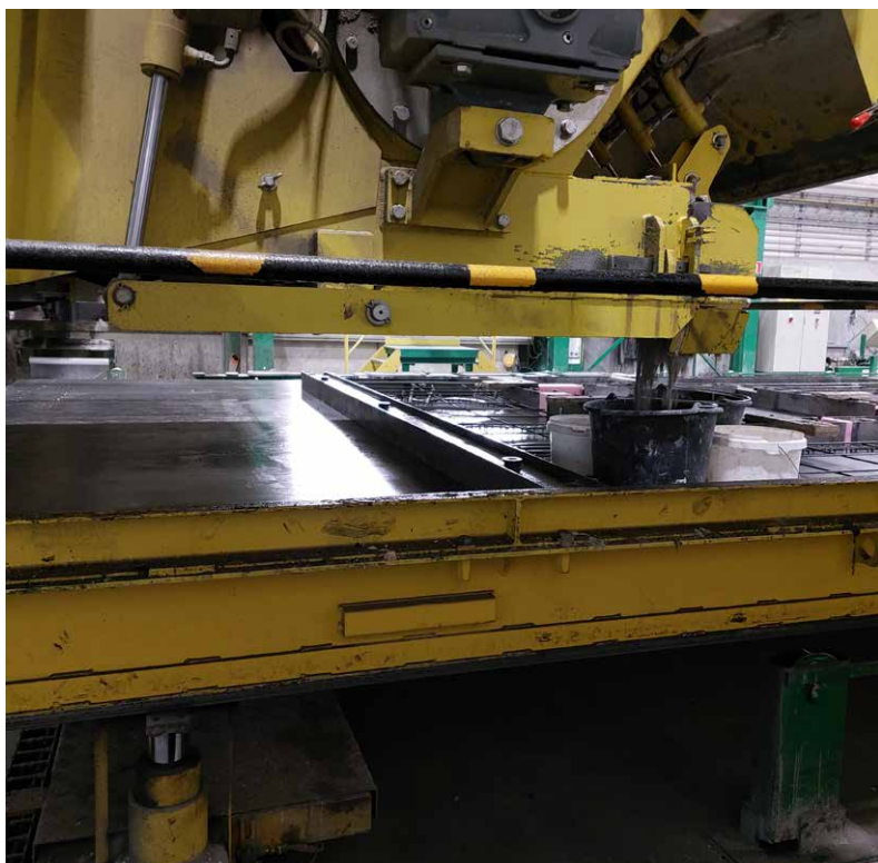
Figuur 2: Storten van beton uit de stortmachine bij Voorbij Prefab (links) en mallen met basaltwapeningsstaven (rechts)
